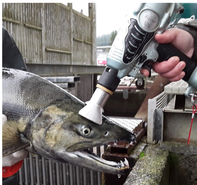
Figure 7. Étourdissement à l'aide d'un appareil pneumatique portatif Source : Bock Industries Inc.
