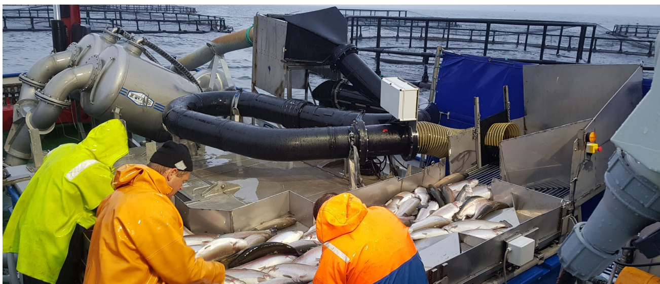
Figure 9. Étourdissement électrique dans l'eau. Source : Ace Aquatec, Écosse
