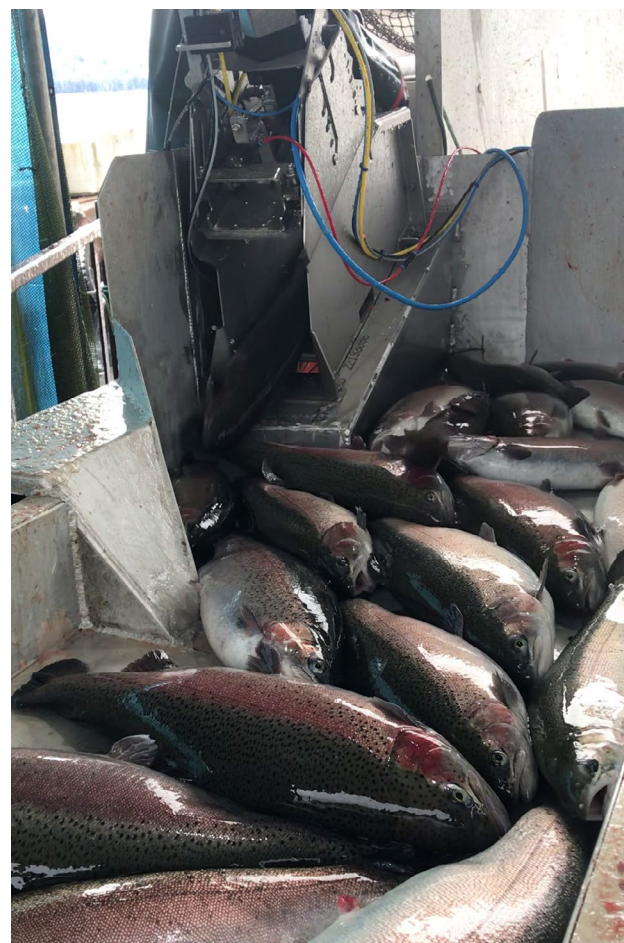
Figure 8. Étourdissement automatisé par percussion Source : Baader
