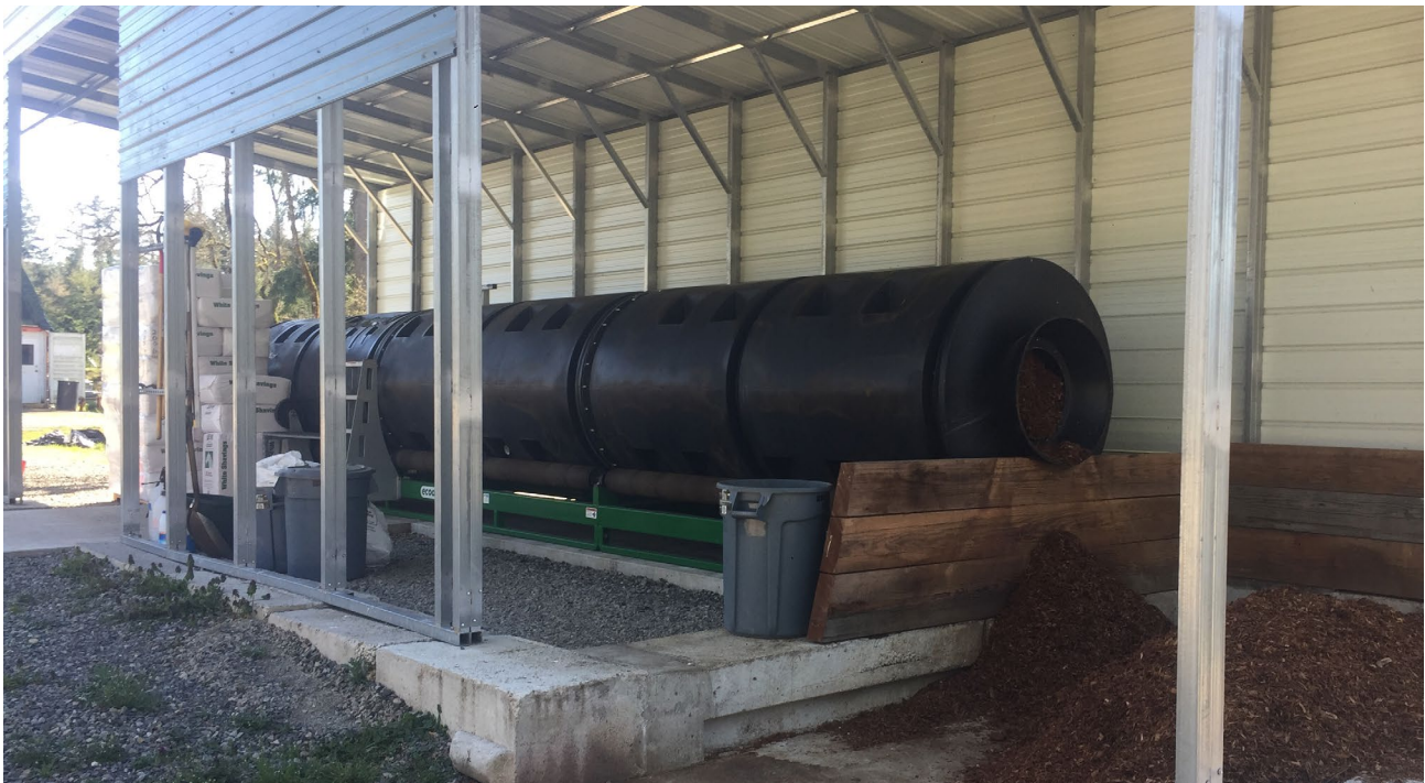
Figure 12. Composteur en contenants Ecodrum MC avec système à air forcé Source : Composteurs Ecodrum MC
